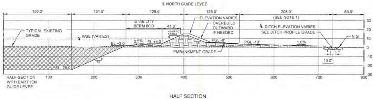
PHASE 2 TYPICAL SECTION (LOOKING DOWNSTREAM) FROM STA 42+00 TO STA 125+00
